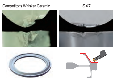
SX7, verbesserter Kerbverschleiß, sehr geringe Ausbrüche an der Schneide gegenüber Whisker
